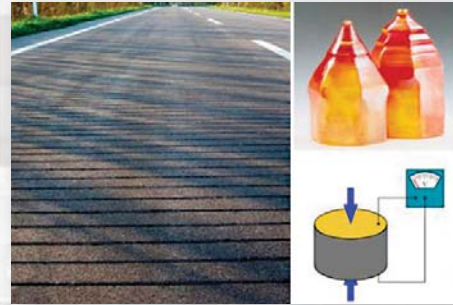
ผลึกแก้วควอตซ์ที่ใช้เปลี่ยนพลังงานจากถนนให้เป็นพลังงานไฟฟ้า
