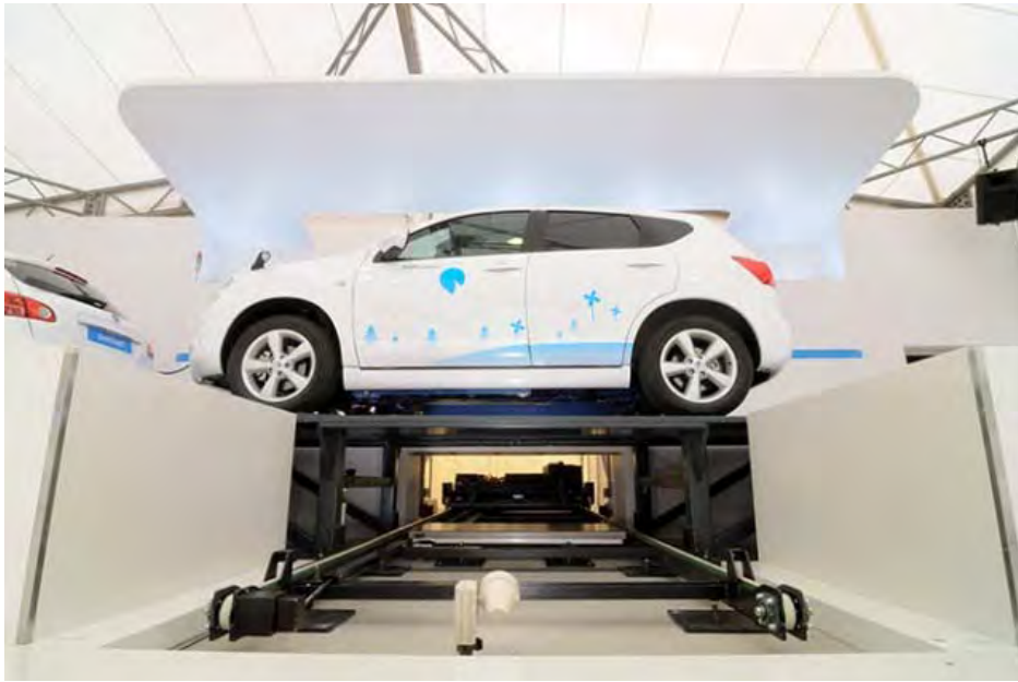
รูปที่ 4-5 สถานีสับเปลี่ยนแบตเตอรี่สำหรับยานยนต์ไฟฟ้า
